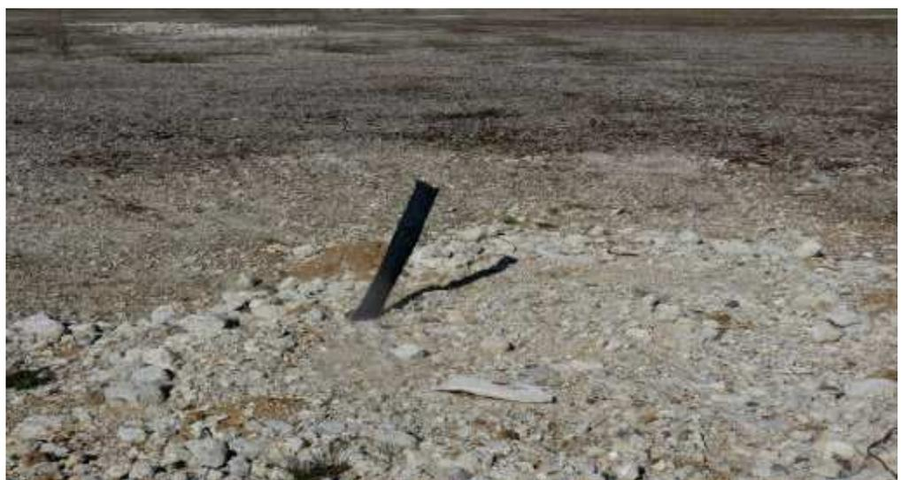
Cliché 10. Vue rapprochée du remblai avec l'alignements des « piézomètres » servant à mesurer le niveau de la nappe phréatique et la composition chimique des eaux.
