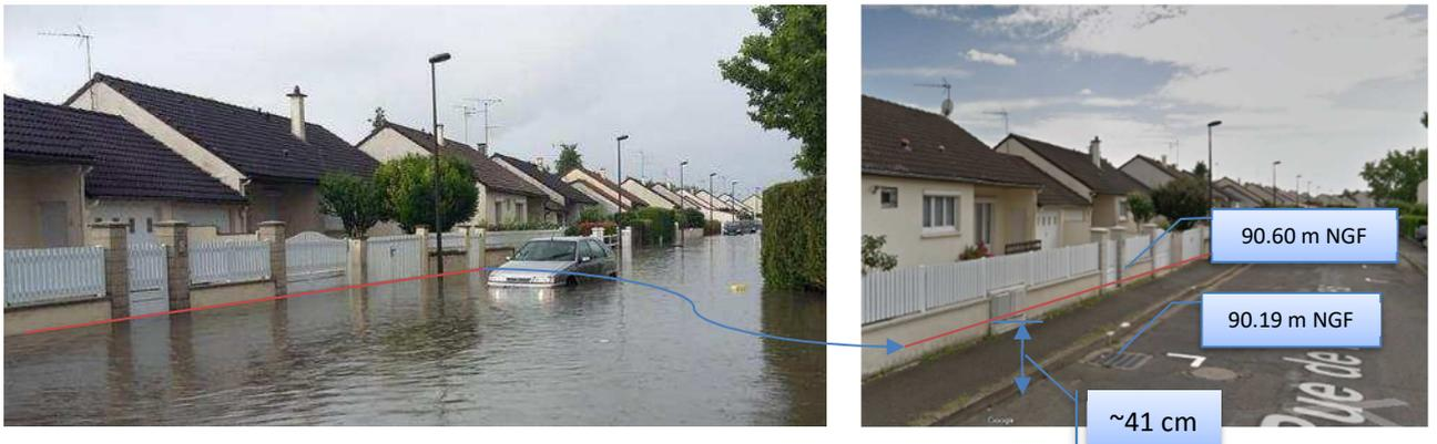
Le calcul du niveau de débordements s'est appuyé sur le Plan Topographique Urbain avec le Modèle Numérique de Terrain (MNT), une photo du 12 juin 2018, et les données du réseau Eaux Pluviales. Le niveau supérieur de l'inondation du 12 juin 2018 a été estimé à 90.60 au 40 rue de la Clarté Dieu.
