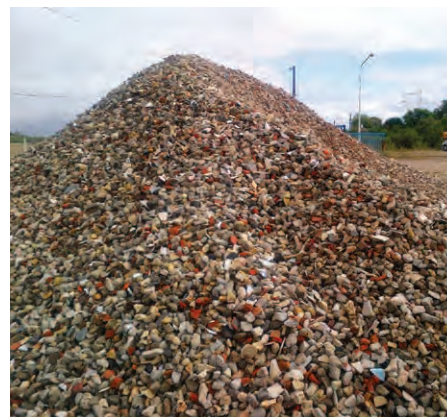
Produit final, valorisé en sous-couche routière
