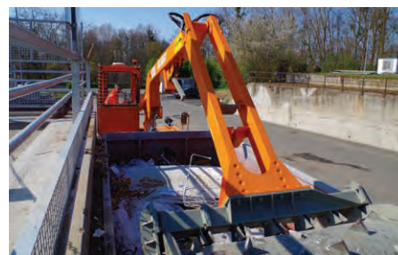
Engin de compaction pour les bennes en déchèterie
