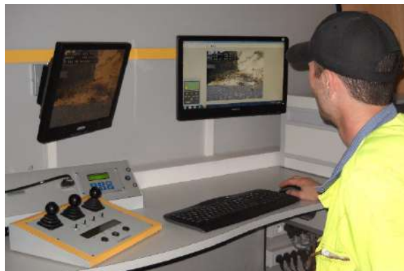
Exemple d'inspection télévisée avec véhicule spécialisé
