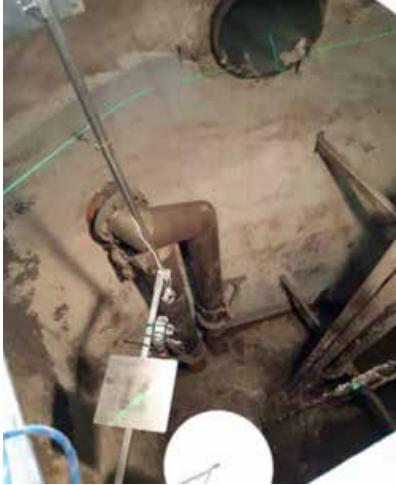
Mire d'étalement positionnée avec un laser Trop-plein des Granges Galand St Avertin
